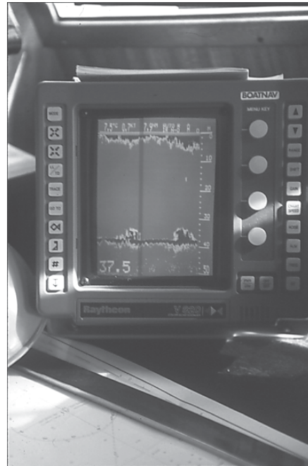
Med dagens ekolod mäter man exakt djup och kan få en tredimensionell bild av bottenprofilen. Foto Putte Frid.
